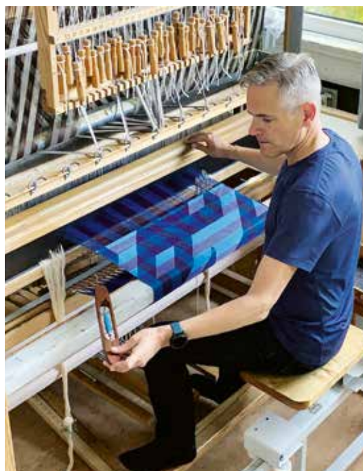
Der blaue Schussfaden ist im Schiffchen aufgewickelt
